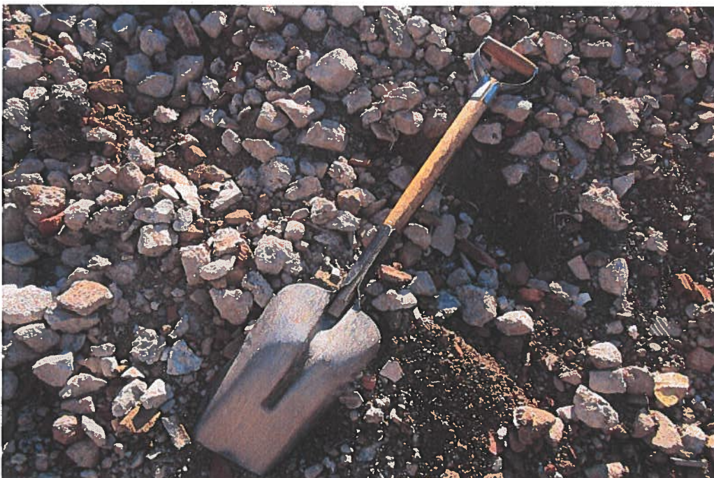
Foto 2: Detailaufnahme der recycelten Gesteinskörnung
